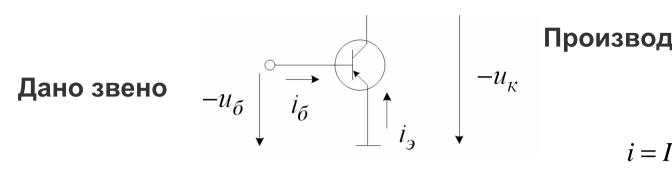
Производит нелинейное преобразование входного сигнала
